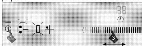
3. Puede ajustar el nivel de temperatura entre los valores 0 y 19 tocando el área de ajuste o deslizando su dedo por dicha área.
