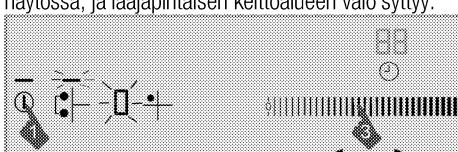
3. Säädä lämpötilataso välille 0 – 19 koskettamalla säätöalueita tai liu'uttamalla sormeasi alueen päällä.
